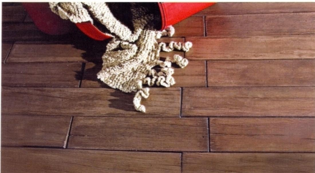
Cimento branco de alta resistência, componentes reciclados e mármore moido formam o revestimento cimentício Legno Parquet (Solarium). As peças de 12,5 x 50 cm e 12,5 x 80 cm, com 2,4 cm de espessura, lembram tacões de madeira. O produto pode ser usado em pisos e paredes de áreas internas e externas (a marca recomenda a aplicação de resina acrílica para dar mais proteção em locais abertos). O material é atémico. Isto é, não esquenta. Soluzione, R\$ 230 o m<sup>2</sup> em ambos os tamanhos.
