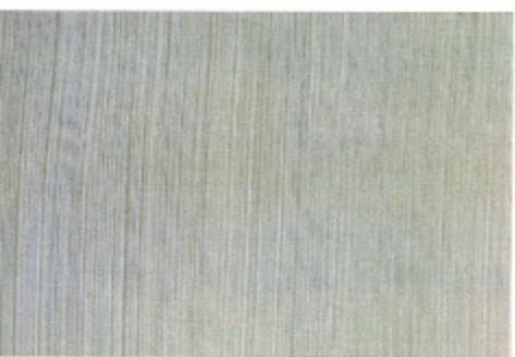
O laminado decorativo de alta pressão da Perotech (aqui na cor Silver Oak) serve para locais secos ou úmidos, mas não para áreas externas. Reveste móveis, pisos (chapás de 60 x 60 cm e 1,25 x 3,08 m) e paredes (placas de 1,25 x 3,08 m para cobrir drywall, alvenaria e azulejos). Uniplac, R\$ 120 o m<sup>2</sup> da versão para parede.
