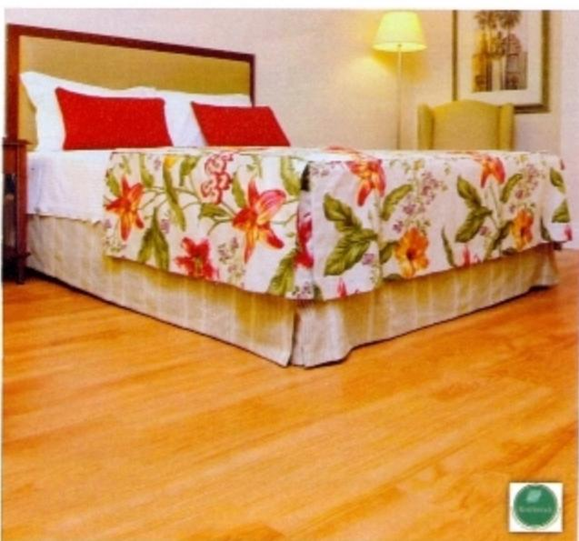
No padrão Duna, as réguas de 15,24 x 91,44 cm do Interwood (Interfloor) provam que PVC também se assemelha à madeira natural. A aplicação se dá com cola branca somente em pisos e paredes internos. Soluzione, R\$ 120 o m<sup>2</sup> instalado.
