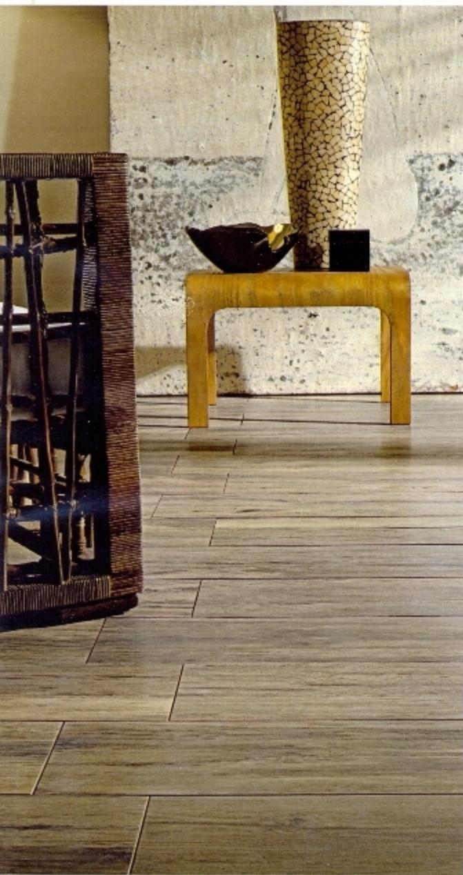
Em sua composição, o porcelanato Ecodiverza Canela Dourada (Portobello) apresenta 18% de material reciclado. As réguas de 0,20 x 1,20 m são assentadas em pisos e paredes de áreas internas e sujeitas à umidade, mas não em espaços em contato constante com a água. C&C, R\$ 162,00/m<sup>2</sup>.
